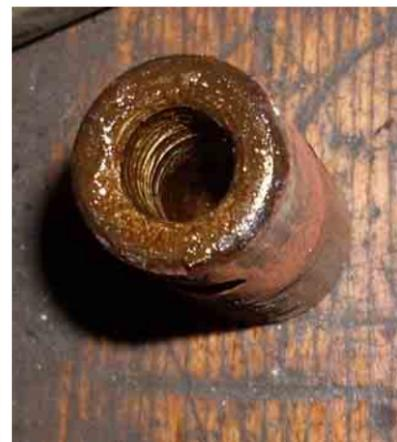
Merkwürdig: funktionsloser Schmiernippel im Gewinde des Bolzens
