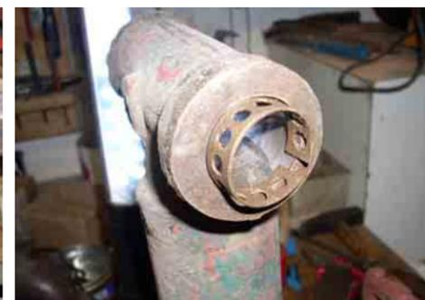
Dank Bügelsäge bekam Udo die alten Buchsen aus der Faustachse. Hier verlässt gerade der Distanzring, der unter dem Schmiernippel sitzt und zwischen den Buchsen das Fett verteilt, seine angestammte Behausung
