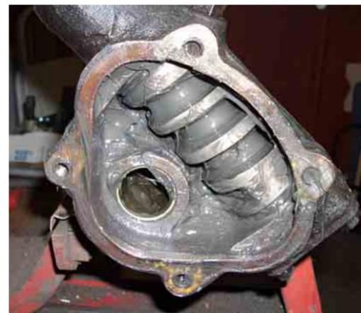
Die Rillen der Lenkschnecke sollte man messen, denn in der Mitte sind sie häufig ausgelaufen
