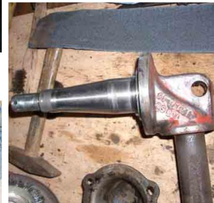
Ein Achsschenkel im unbearbeiteten Zustand. Udo musste eine kleine Buchse darüber stülpen, damit das Rollenlager wieder drauf passt
