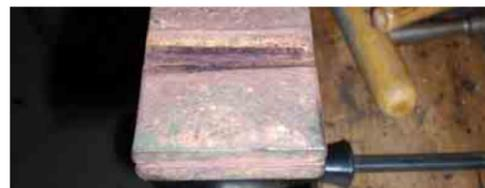
Abgenudelt: Die Blattfeder hatte sich auf dem Gleitbolzen eingeschliffen
