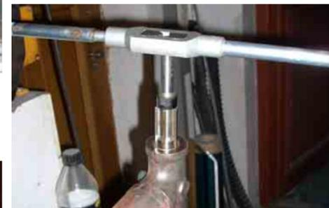
Mit der Reibahle werden die Buchsen der Faustachse exakt auf Maß gebracht
