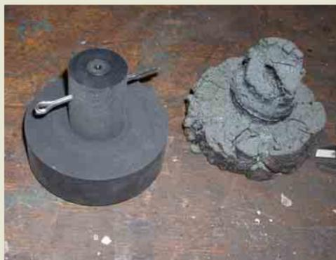
Rechts: ein Anschlagpuffer nach 54 Jahren Witterung und Öl. Links: Udos neuer Puffer
