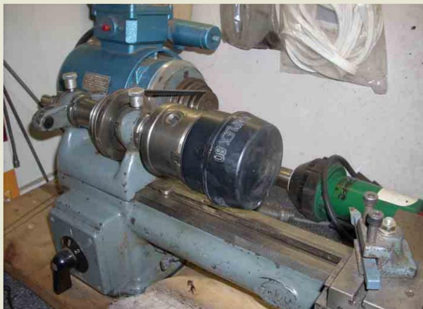
Gummikopf eines Simplex-Gummihammers in der kleinen Drehbank. Er ist etwas größer als der Außendurchmesser des Anschlagpuffers.
