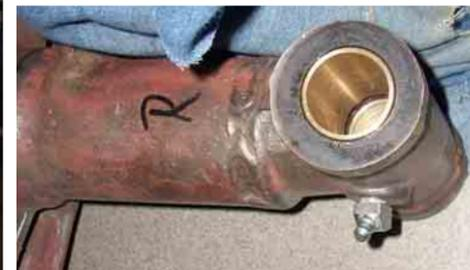
Eine neue, selbst gedrehte Buchse steckt in der Faustachse
